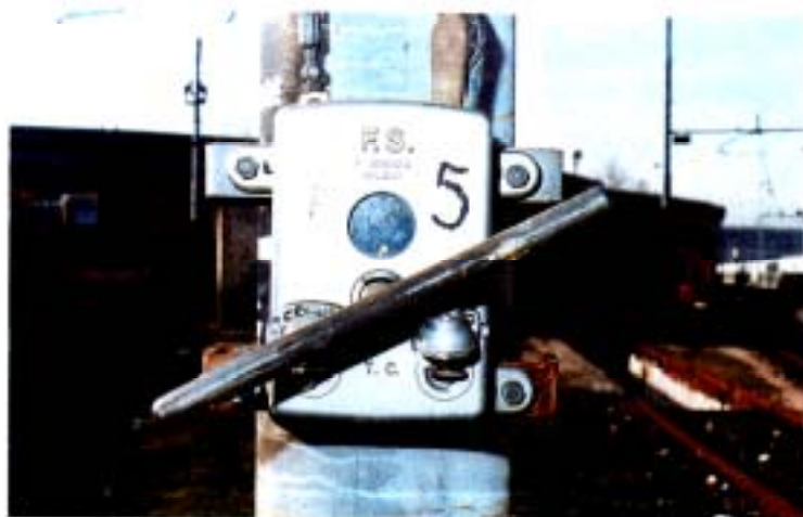
Figura 15: Argano a manovra manuale in posizione di aperto
