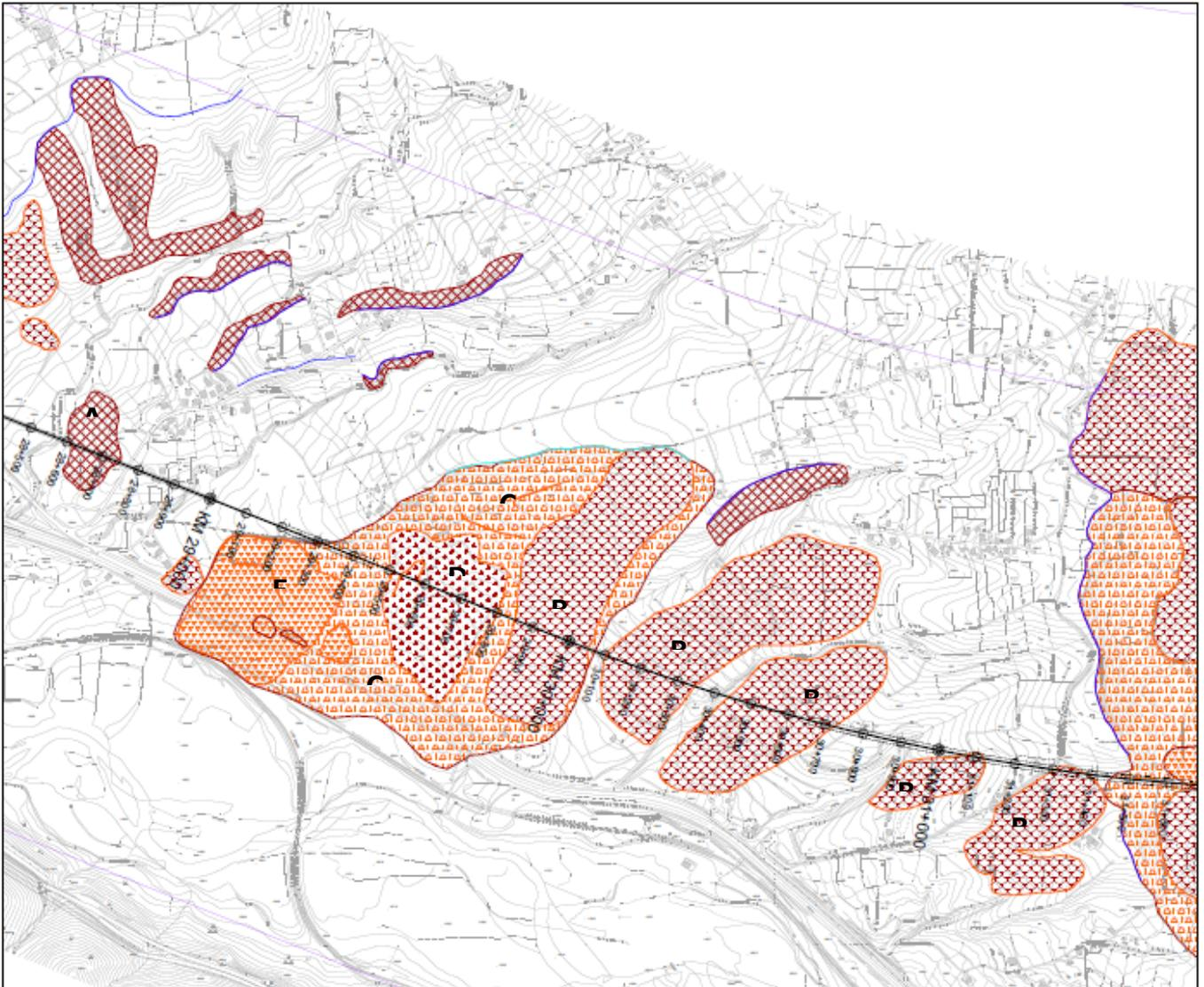
Figura 52 – Rappresentazione, su cartografia CTR della Regione Campania in scala 1:18.000, degli elementi geomorfologici rilevati nell’ambito del PFTE che mostra la presenza di alcune frane complesse, franosità diffusa per colamento lento e movimenti complessi, frane per colamento lento e frane per scivolamenti rotazionali che caratterizzano l’area compresa tra la pk 29+000 e 31+500 circa.
