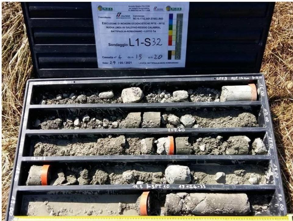
Figura 23 – Livelli ghiaioso-sabbiosi nei depositi BTL-PLMa intercettati nel sondaggio S32 tra 15 e 20 m da p.c.
