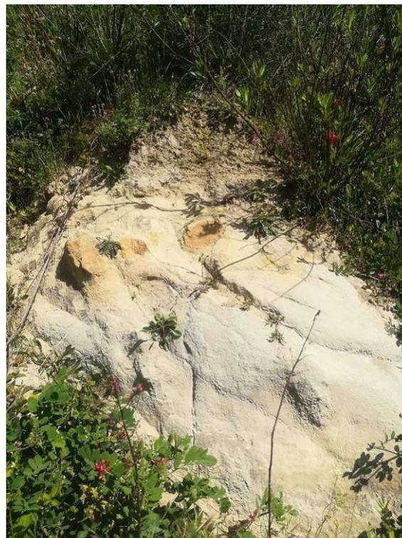
*Figura 15 – SGH: arenarie giallastre massive intercalate alle argille.*
