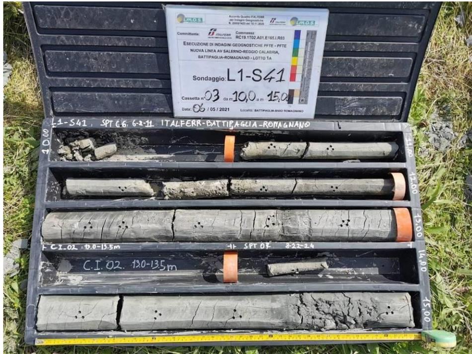
Figura 22 – Livelli argillosi nei depositi BTL-PLMa intercettati nel sondaggio S41 tra 10 e 15 m da p.c.
