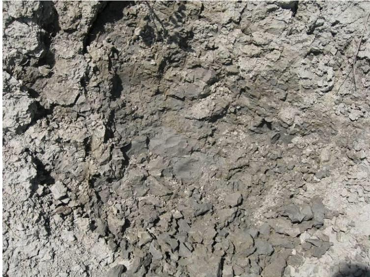
*Figura 14 – SGH: frazione argilloso-siltosa caratterizzata da stratificazione mal definita.*
