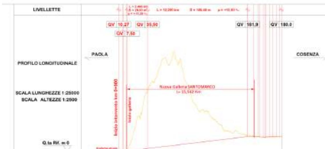
In uscita dai due cameroni i 4 binari si collocano in quattro distinte gallerie a singolo binario, in particolare le due gallerie del binario pari e dispari del raddoppio in direzione Paola, sottapassano l'attuale linea ferroviaria a singolo binario San Lucido-Cosenza, per poi lasciare la galleria e posizionarsi in stretto affiancamento alla linea Tirrenica fino all'ingresso dell'impianto di Paola.
