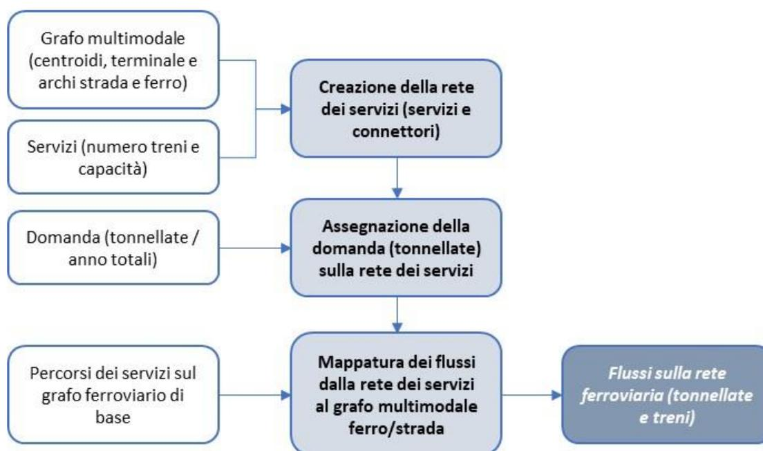
Figura 106 – Procedura di assegnazione del traffico ferroviario nel modello attuale
