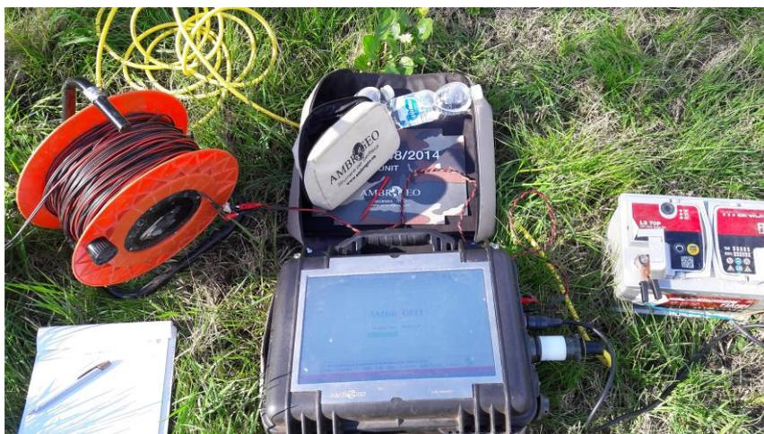
Figura 2.2.1.1: Sismografo digitale a 24 bit.
