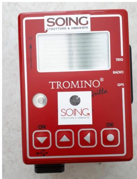
Figura 2.3.2.1: Tromografo per la misura microtremori - TROMINO©Engi.
