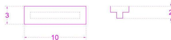
*Fig. 72 – layout di scavo*
