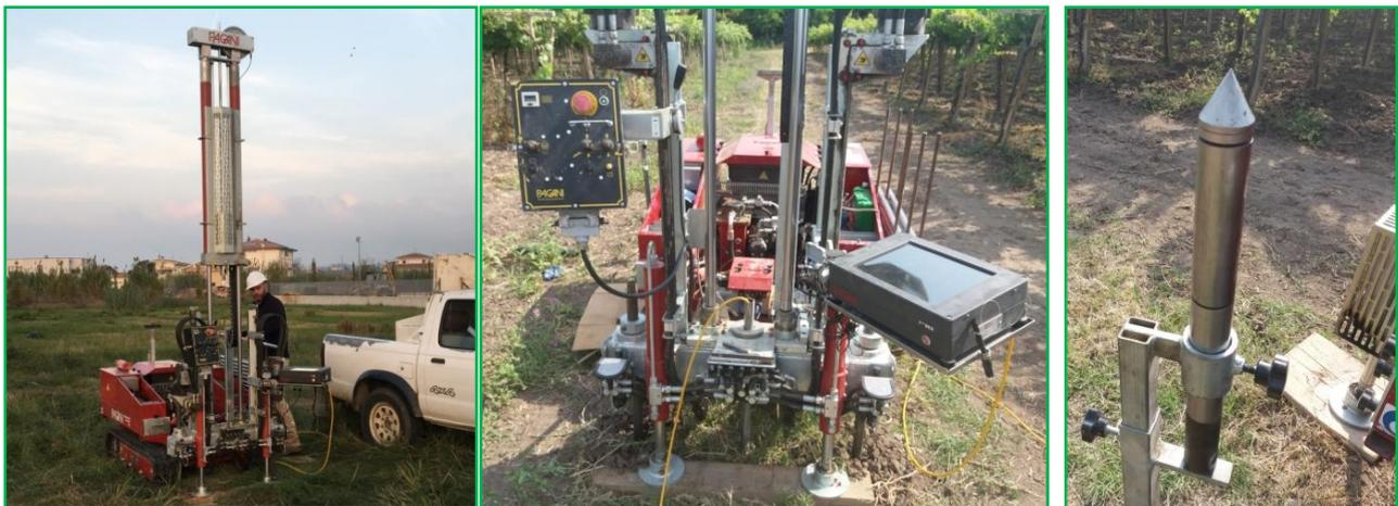
Foto 5.1 - Penetrometro con piezocono utilizzato.
