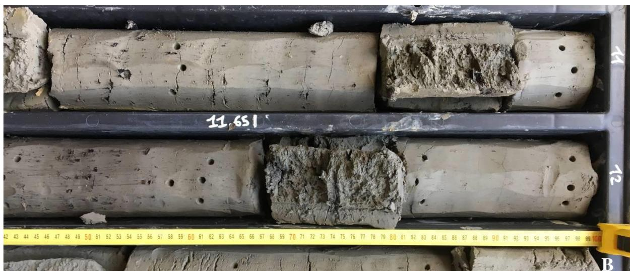
**Figura 6-11.** Foto del sondaggio S10 (tra 5 e 10m) in cui le alluvioni si presentano limoso-sabbiose oca marrone chiaro (a) e particolare del sondaggio S16 in cui si intercettano livelli di materia organica all'interno dei limi-argillosi grigi (b).
