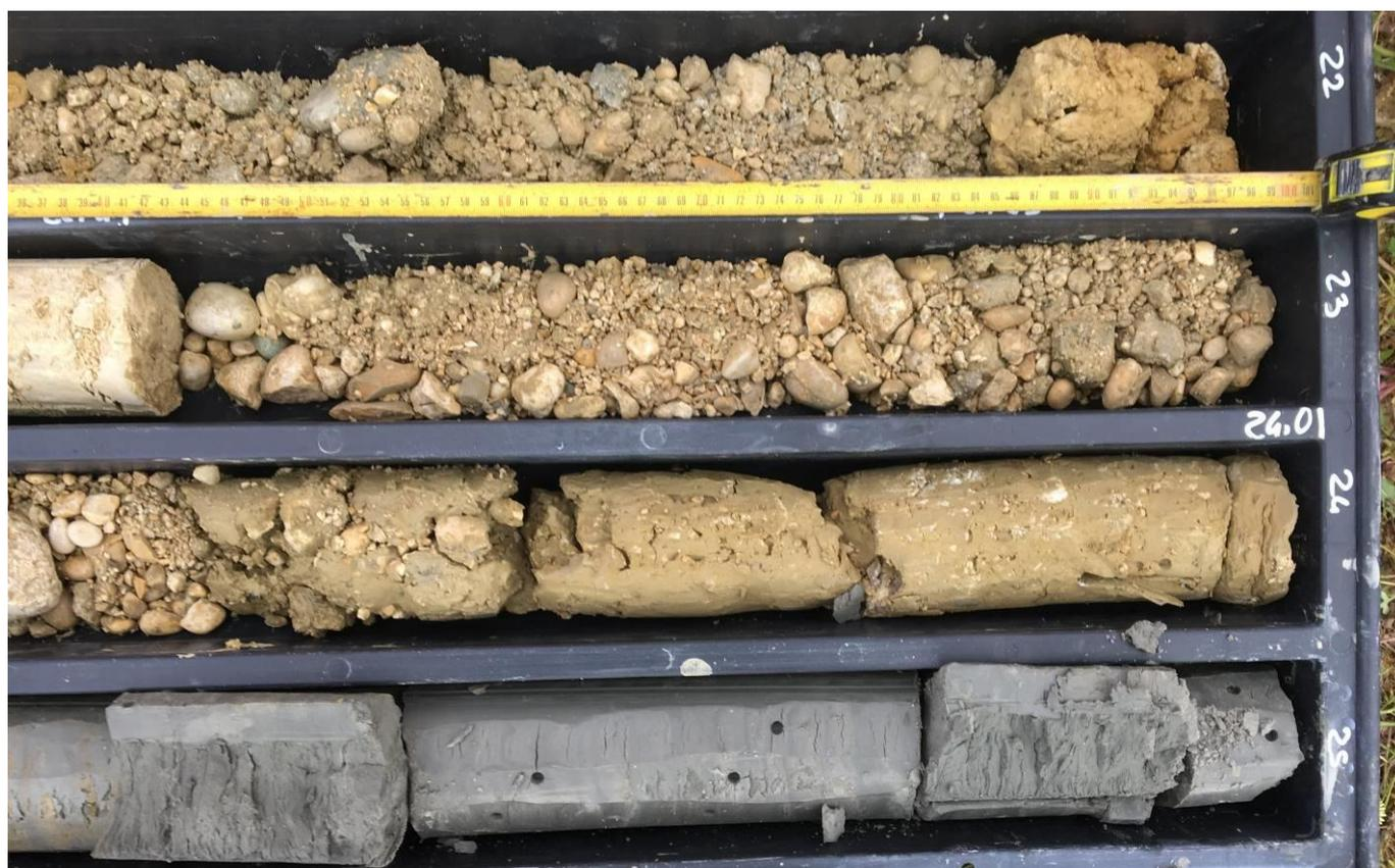
**Figura 6-10. Foto rappresentativa del sondaggio S15, in cui si possono distinguere uno strati ghiaioso-sabbiosi di colore giallastro con intercalazione di materiale di limo-sabbioso e sabbioso, a profondità di 25m si nota il passaggio con le argille grigio-azzurre**
