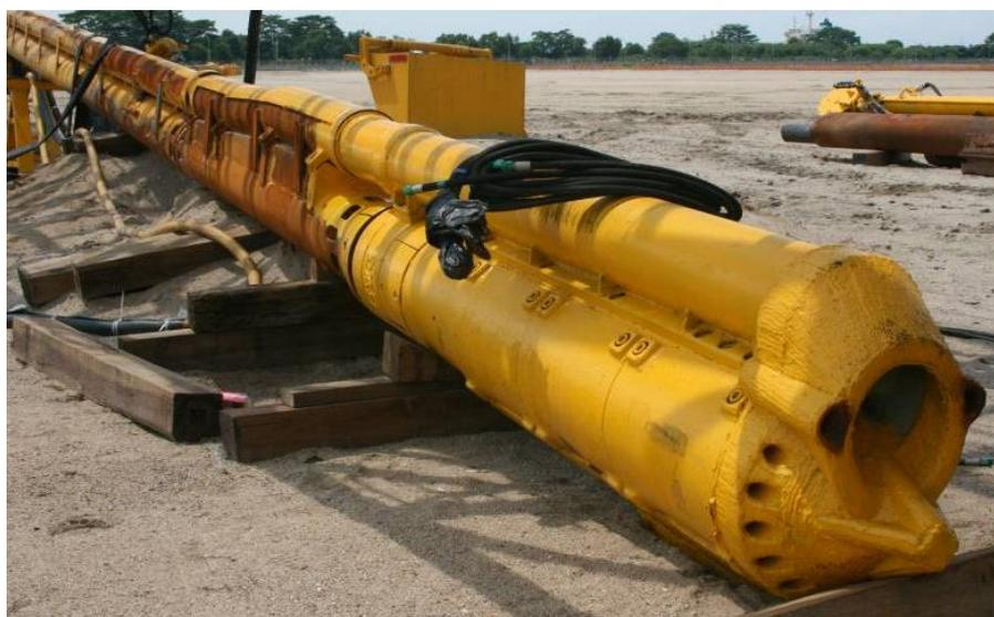
*Figura 6: Tipica attrezzatura per colonne di ghiaia con immissione della ghiaia a secco a fondo foro – Dettaglio della punta dell'utensile (nota ugelli per l'iniezione di acqua o aria) e tubo di consegna ghiaia*
