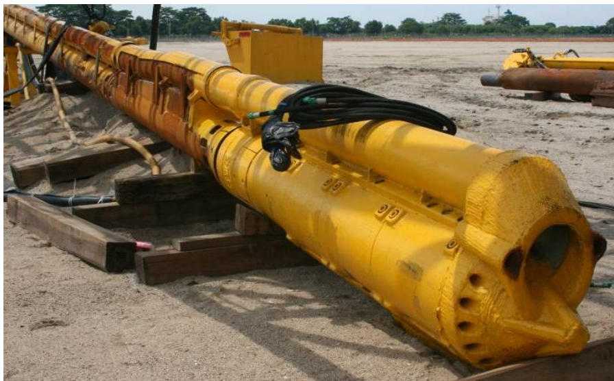
Figura 7: Tipica attrezzatura per colonne di ghiaia con immissione della ghiaia a secco a fondo foro – Dettaglio della punta dell'utensile (nota ugelli per l'iniezione di acqua o aria) e tubo di consegna ghiaia
