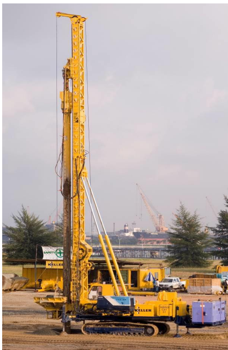
Figura 6: Tipica attrezzatura per colonne di ghiaia con immissione della ghiaia a secco a fondo foro
