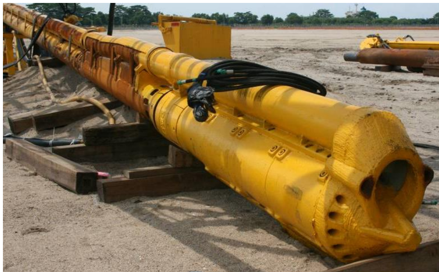
Figura 10: Tipica attrezzatura per colonne di ghiaia con immissione della ghiaia a secco a fondo foro – Dettaglio della punta dell'utensile (nota ugelli per l'iniezione di acqua o aria) e tubo di consegna ghiaia
