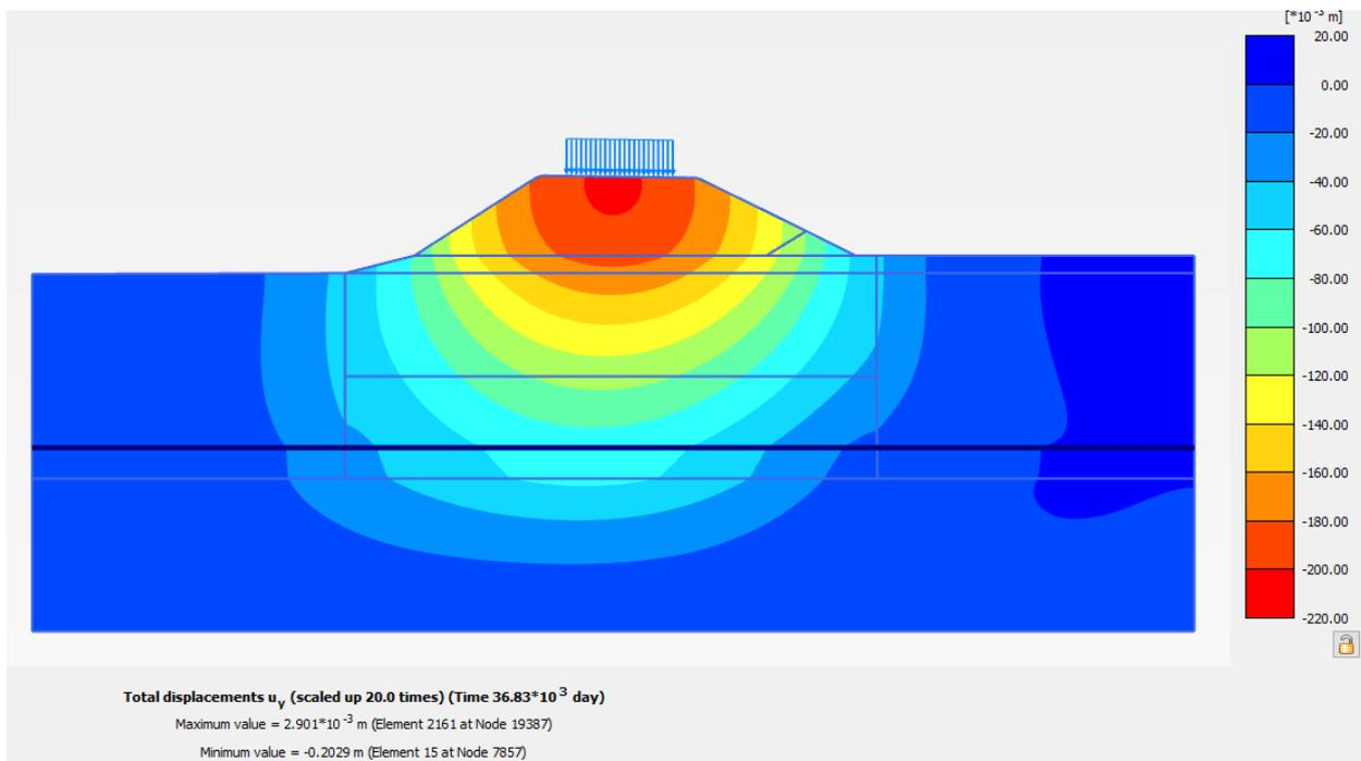
Figura 26: Rilevato sez. DD di IV02 senza interventi – Spostamenti verticali dopo 100 anni da fine costruzione rilevato stradale
