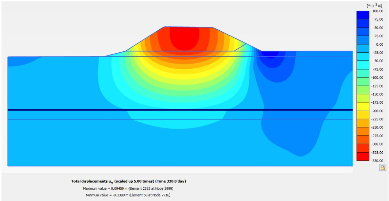
Figura 18: Rilevato sez. DD di IV02 senza interventi – Spostamenti verticali a fine costruzione rilevato stradale
