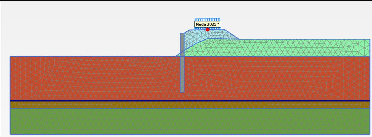
Figura 11: Rilevato sez. 9 di IV02 senza interventi – Punti di interesse per calcolo spostamenti verticali
