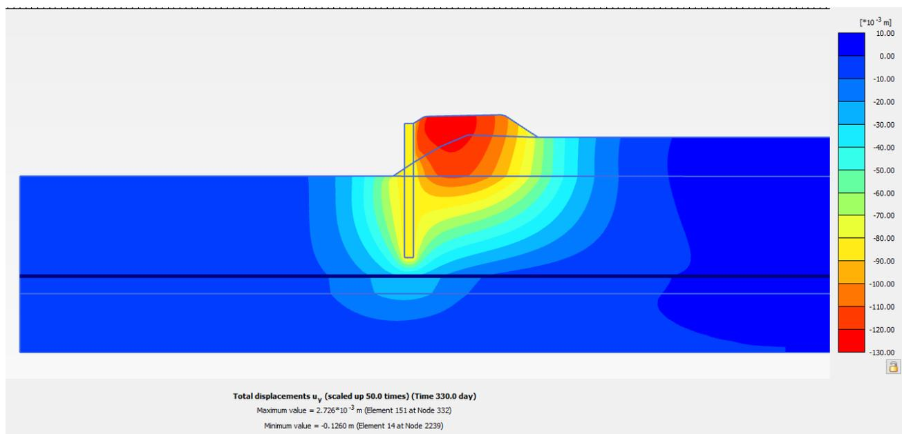
Figura 12: Rilevato sez. 9 di IV02 senza interventi – Spostamenti verticali a fine costruzione rilevato stradale
