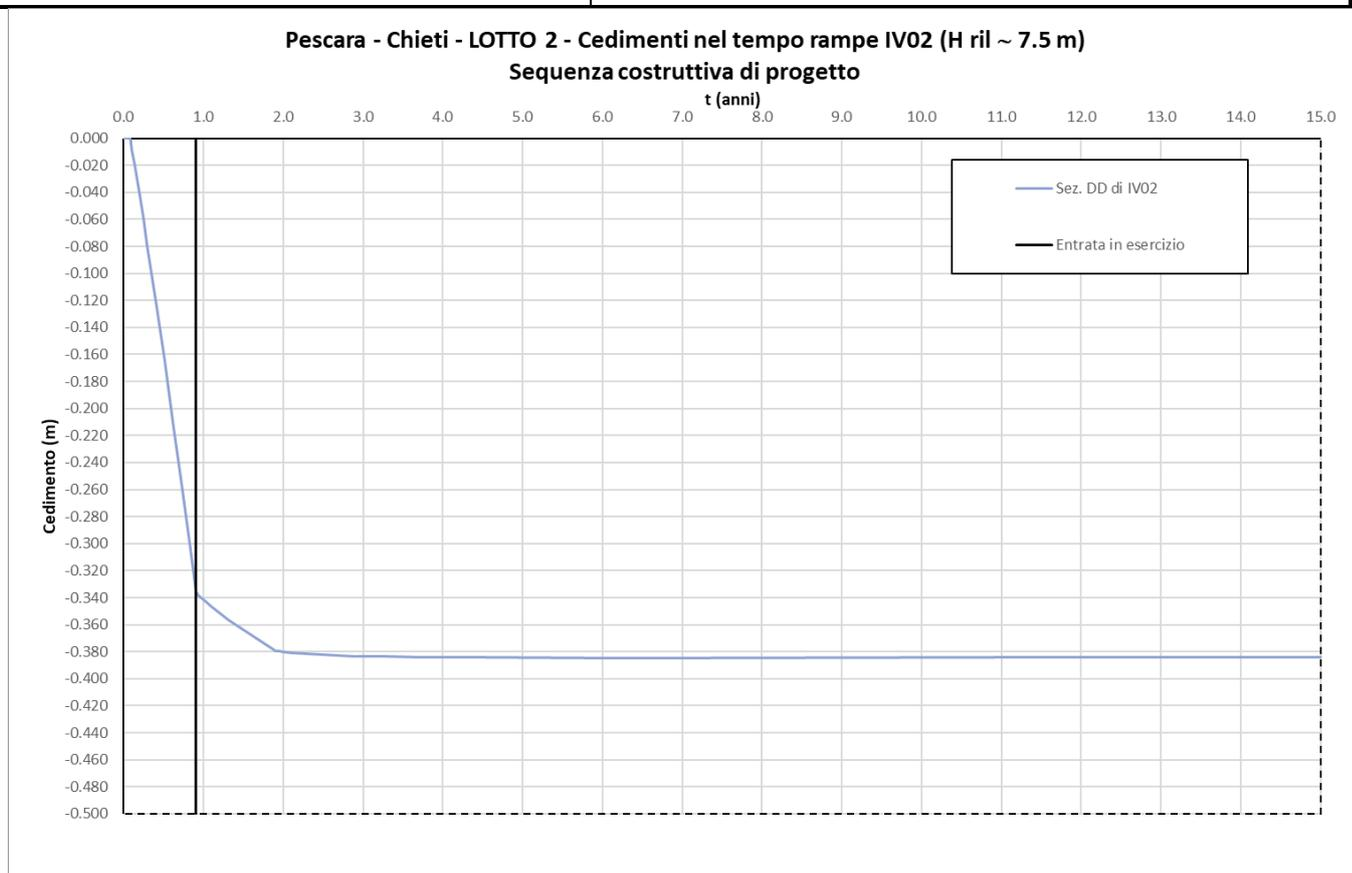
Figura 20: Rilevato sez. DD di IV02 senza interventi – Spostamenti verticali nel tempo in sommità al rilevato
