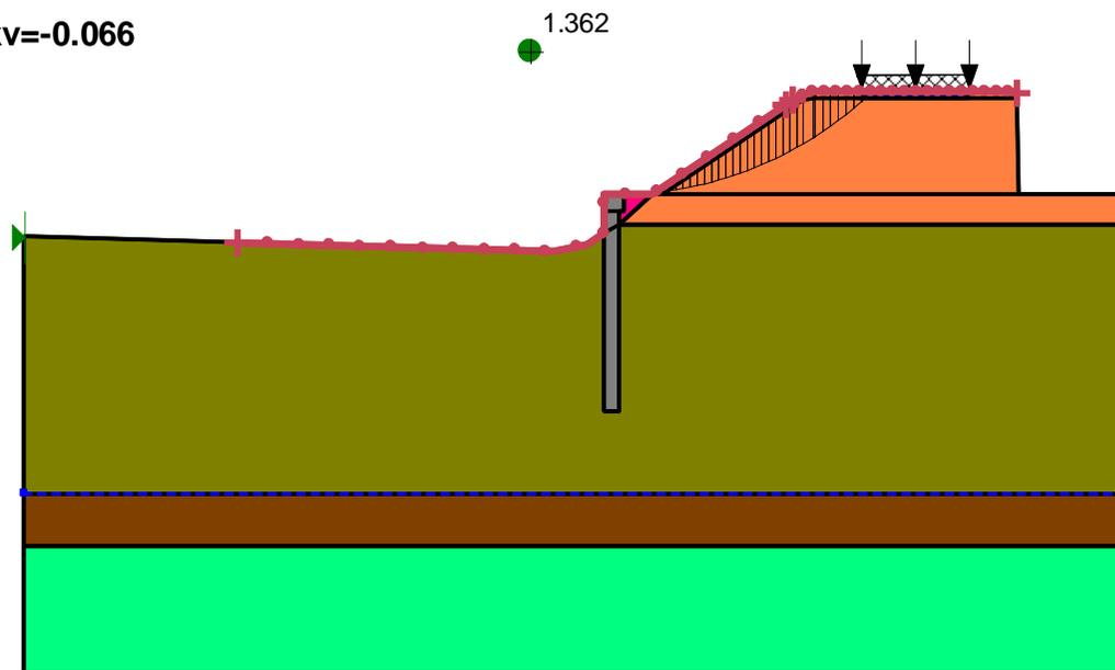
Figura 8: Rilevato  $H=5.5$  m, sez. 6 di IV02 - Analisi di stabilità globale in campo sismico-condizioni co-sismiche (+)
