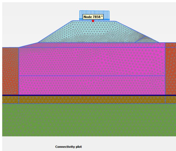
Figura 24: Rilevato sez. DD di IV02 con interventi – Punti di interesse per calcolo spostamenti verticali
