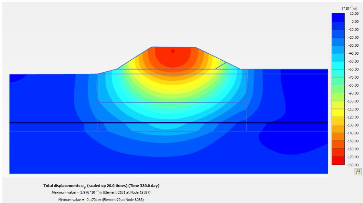
Figura 25: Rilevato sez. DD di IV02 senza interventi – Spostamenti verticali a fine costruzione rilevato stradale
