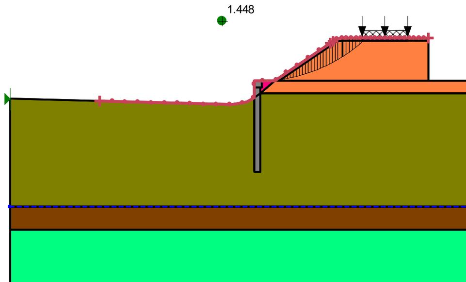
Figura 7: Rilevato H=5.5 m, sez. 6 di IV02 - Analisi di stabilità globale in campo statico DA1
