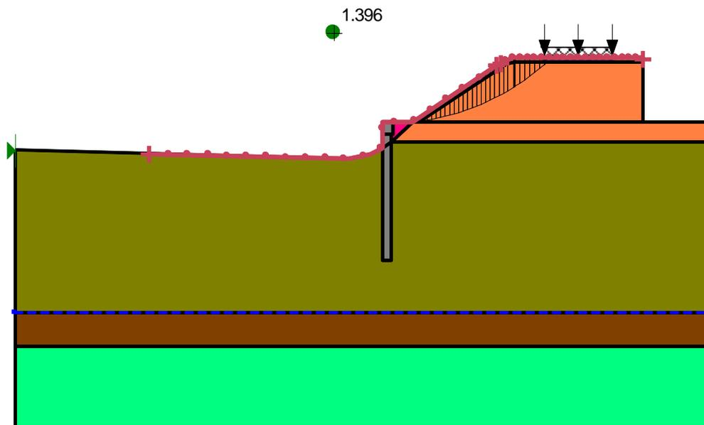
Figura 9: Rilevato  $H=5.5$  m, sez. 6 di IV02 - Analisi di stabilità globale in campo sismico - condizioni co-sismiche (-)
