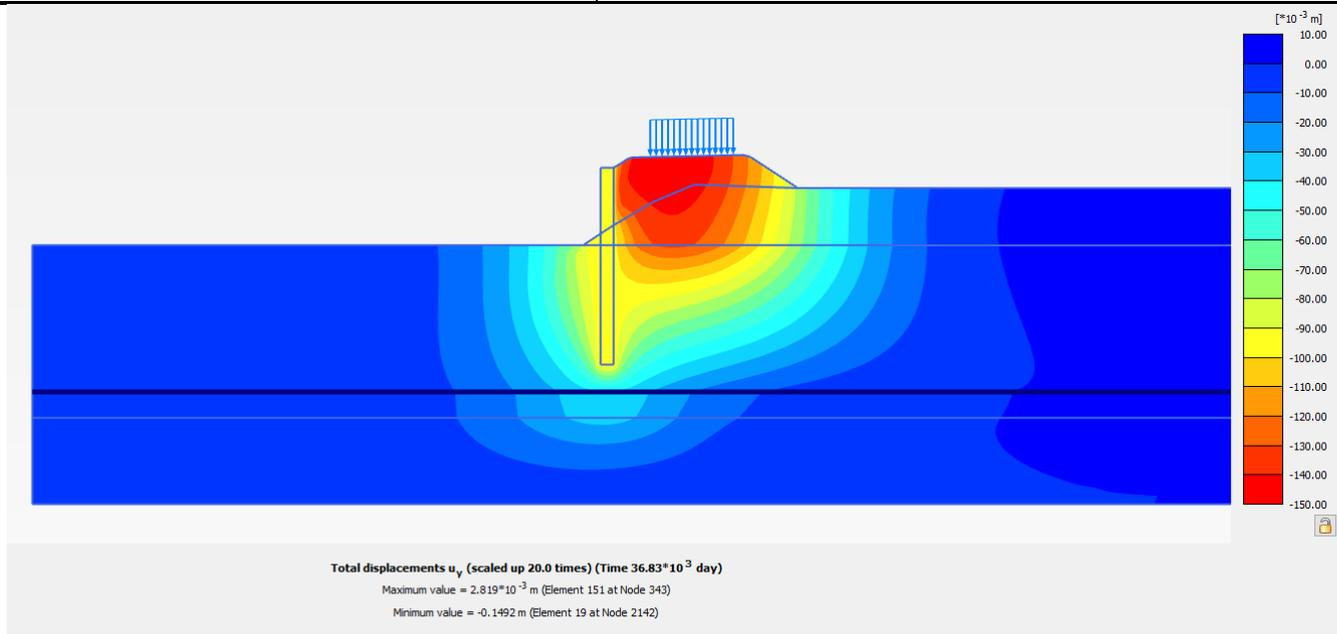
Figura 13: Rilevato sez. 9 di IV02 senza interventi – Spostamenti verticali dopo 100 anni da fine costruzione rilevato stradale
