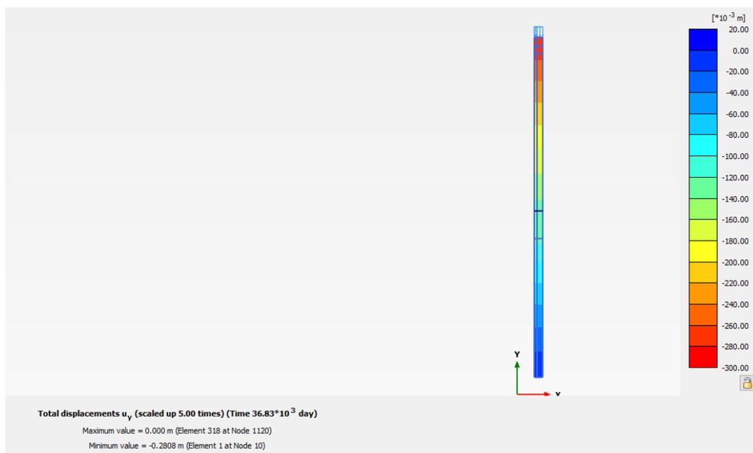
Figura 22: Modello assialsimmetrico DCM maglia quinconce di interasse 2.5 m per rilevato H 7 m – Spostamenti verticali a lungo termine (Sez. DD di IV02)
