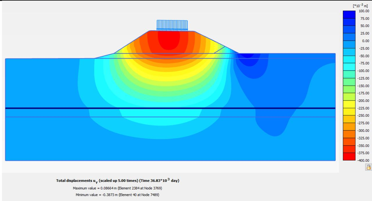
Figura 19: Rilevato sez. DD di IV02 senza interventi – Spostamenti verticali dopo 100 anni da fine costruzione rilevato stradale
