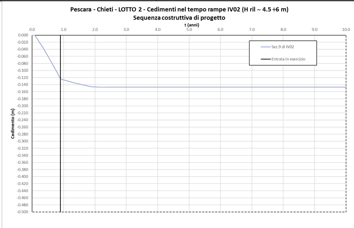
Figura 14: Rilevato sez. 9 di IV02 senza interventi – Spostamenti verticali nel tempo in sommità al rilevato
