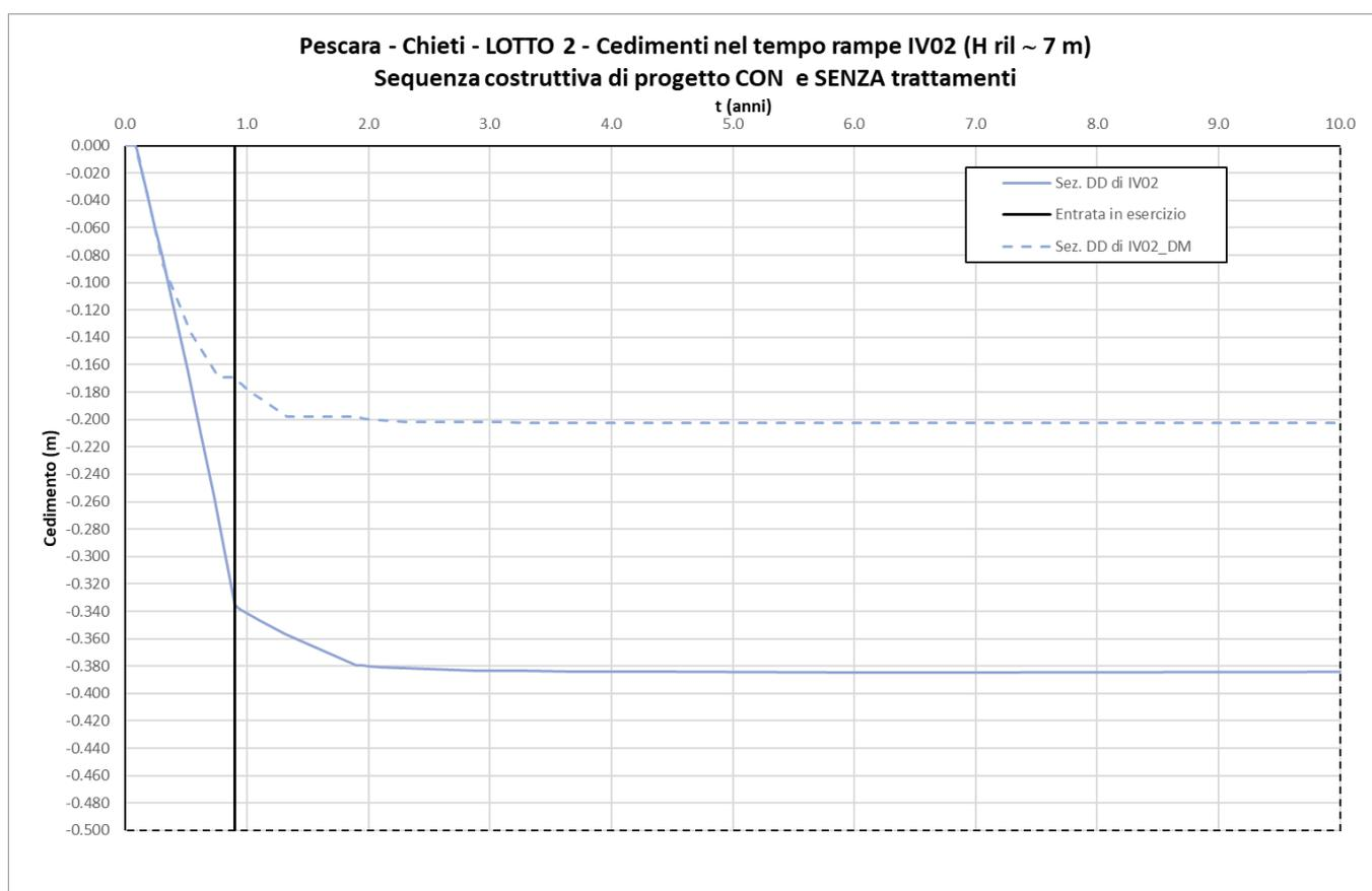
Figura 27: Rilevato sez. DD di IV02– Spostamenti verticali nel tempo in sommità al rilevato
