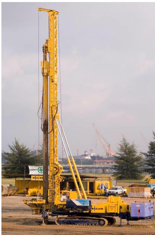
Figura 4: Tipica attrezzatura per colonne di ghiaia con immissione della ghiaia a secco a fondo foro
