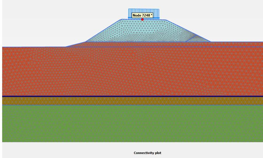
Figura 17: Rilevato sez. DD di IV02 senza interventi – Punti di interesse per calcolo spostamenti verticali
